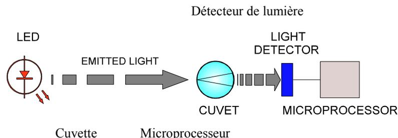
Une diode électroluminescente monochromatique (Led) émet un rayonnement à une longueur d'onde unique éclairant le système avec une intensité lumineuse  $I_0$ .
